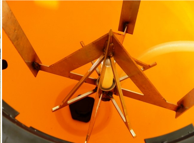
Abb. 2 und 3: Gesamtansicht der Mischstation (Bild links) mit Motorpumpe und 3" Sauganschluss. In der Einfüllöffnung ist eine Vorrichtung zum Aufstechen der Gebinde integriert. Nach dem Ablauf des Inhaltes kann über die Gebindereinigung gespült werden. Am Behälterboden ist eine Strudelbremse installiert.
