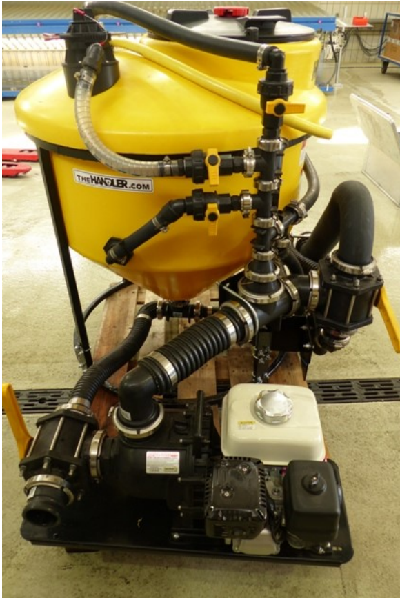
Abb. 2 und 3: Gesamtansicht der Mischstation (Bild links) mit Motorpumpe und 3" Sauganschluss. In der Einfüllöffnung ist eine Vorrichtung zum Aufstechen der Gebinde integriert. Nach dem Ablauf des Inhaltes kann über die Gebindereinigung gespült werden. Am Behälterboden ist eine Strudelbremse installiert.
