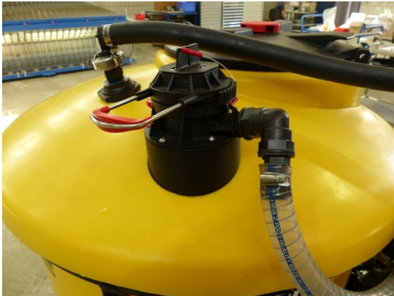
Bild 5: Der optionale Füllanschluss EasyFlow ist an der Behälteroberseite montiert.
