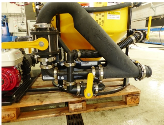
Bild 6: In der Bildmitte der Injektor zum Ansaugen von vorgemischten Pflanzenschutzmitteln aus dem Mischbehälter oder über eine zweite Leitung aus einem Großgebinde.
